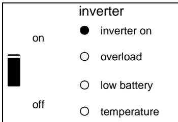
Der Wechselrichter ist in Betrieb und Strom fließt zu den Verbrauchern.
