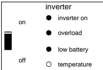
El inversor se ha parado debido a un exceso de tensión de ondulación en los terminales de la batería.
