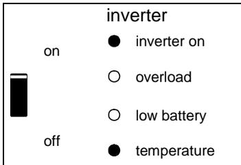
Der Wechselrichter hat sich wegen erhöhter Gerätetemperatur abgeschaltet.
