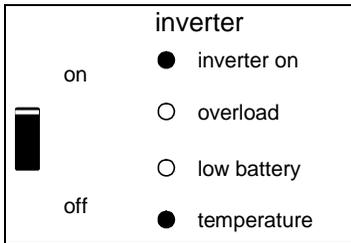
El inversor se ha parado debido a la temperatura excesiva de los componentes electrónicos.
