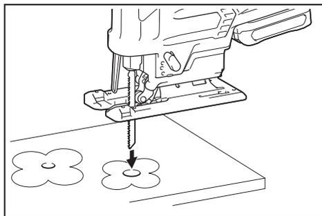
Para recortes internos sin un corte de entrada desde un borde, perforo previamente un orificio inicial de 12 mm (15/32") o más de diámetro. Inserte la segueta caladora en este orificio para empezar su corte.
