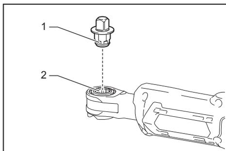
► 1. Adaptador del dado 2. Orificio del adaptador
