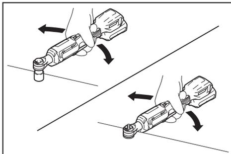
**AVISO:** Una torsión de apriete excesiva puede dañar el perno/tuerca, el dado o la herramienta.
